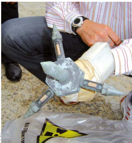
Paratonnerre radioactif de type Ionix, dont les trois flèches contiennent des sources d'américium 241.
