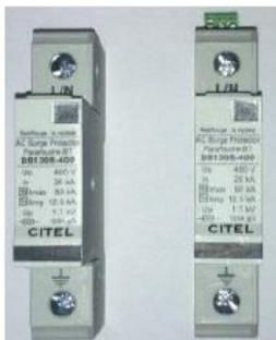
Le ADS 130R-400 est un parafoudre pour réseaux BT, particulièrement utile dans des régions à très forte densité de foudroiement, où le risque courant de foudre ou même d'impact direct est maximum. Il permet de protéger un réseau monophasé ou triphasé en mode commun.
