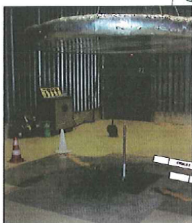
Paratonnerre CIRRUS en essai au Cegely de Lyon
